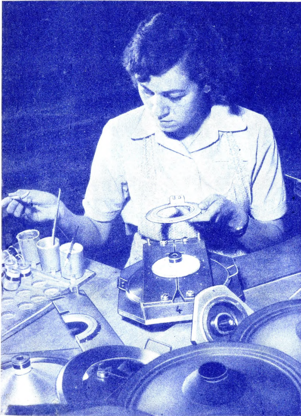
Bei den Geräten der neuen Saison wird der Klangqualität und damit den Lautsprechern ganz besondere Aufmerksamkeit gewidmet. Hier ein Bild aus der Fertigung der Lorenz-Celophon-Lautsprecher. Genau gearbeitete Spannvorrichtungen sorgen für einwandfreie Zentrierung sowohl beim Verkleben der leichten Schwingspule mit der elliptisch gekrümmten Membran als auch beim Aufsetzen der Gewebezentrirmembran und ihrer ringförmigen Halterung. (Aufnahme: C. Stumpf)
